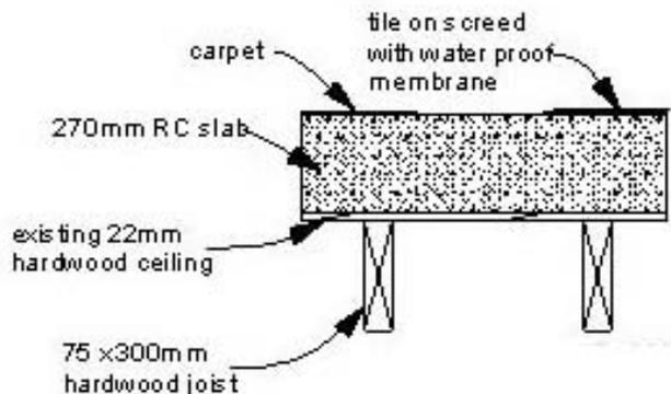
**FIGURE 17 – FLOOR / CEILING DETAIL SYSTEM 270mm**
